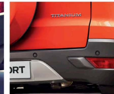
ชุดเซ็นเซอร์ระยะถอยหลัง ช่วยเพิ่มความปลอดภัยระหว่างถอยจอด ด้วยเซ็นเซอร์ 4 จุด
